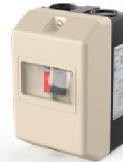
Motorschutzschalter SMB 3-poliger Motorschutzschalter mit thermischer Magnetentriegelung und Phasenausfallschutz Zur Bedienung und zum Schutz von Ventilatormotoren.
