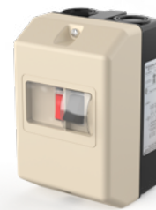
Motorschutzschalter SMB 3-poliger Motorschutzschalter mit thermischer Magnetentriegelung und Phasenausfallschutz Zur Bedienung und zum Schutz von Ventilatormotoren.
